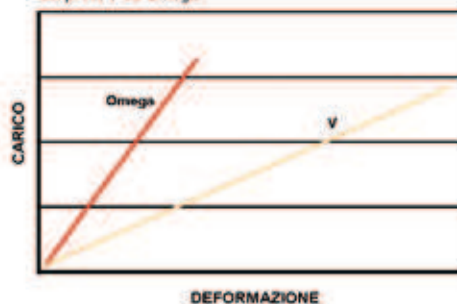
comparazione qualitativa delle curve carico / deformazione dei profili V ed Omega
